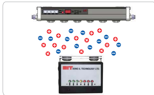
离子发生器下端, 产品通过的距离测量离子平衡度的偏向与否
