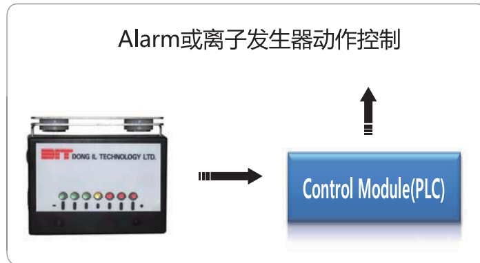
输出与测量数据成比例的模拟信号, 可实现与PLC等外部控制模块的联动管理
